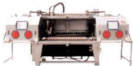
Injektor-Sonderstrahlanlage 2.000 mm breit mit seitlich aufschiebbaren Türen, mit einer eingebauten Walzendrehvorrichtung zum Strahlen von Wellen
